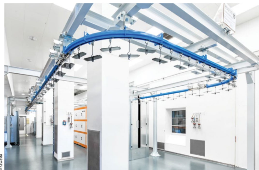
Eine passende Kettenteilung hat einen großen Einfluss auf die Auslastung der Gesamtanlage.
