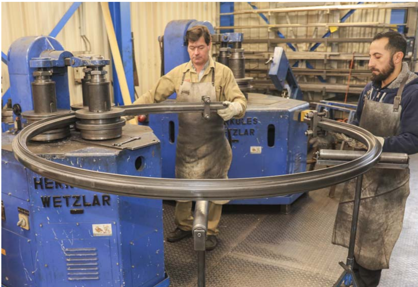
Kewesta-Mitarbeiter formen die Bögen in verschiedensten Durchmessern für die Schienensysteme vor Ort. Überhaupt profitieren die Kunden von einer fast 90-prozentigen Fertigungstiefe.
